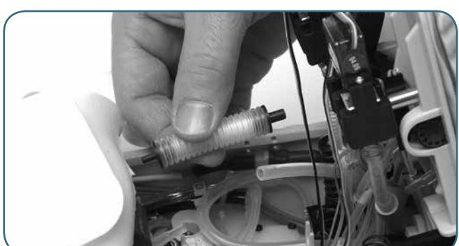
断开过滤器装配件并换上新的过滤器装配件。
