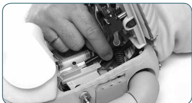
将新气胸气囊插入胸腔内并重新连接至铜头。
