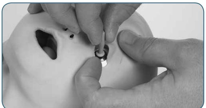
瞳孔をシミュレータに取り付けるには、指を使ってまぶたを開き、付属交換用器具を使用して台座から瞳孔を取り外し、同じ器具を使用して希望する瞳孔を台座にはめ込みます。
