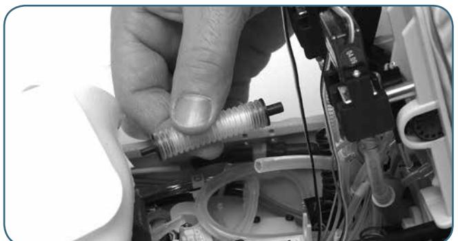
フィルター式を取り外し、新しいものと交換します。
