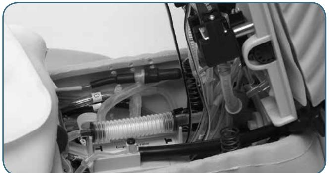
内側が見えるように胸部プレート式を持ち上げ、フィルタホルダーを見つけます。
